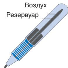
Специальный резервуар для компенсации перепадов давления между внутренним резервуаром и давлением воздуха в самолете.
